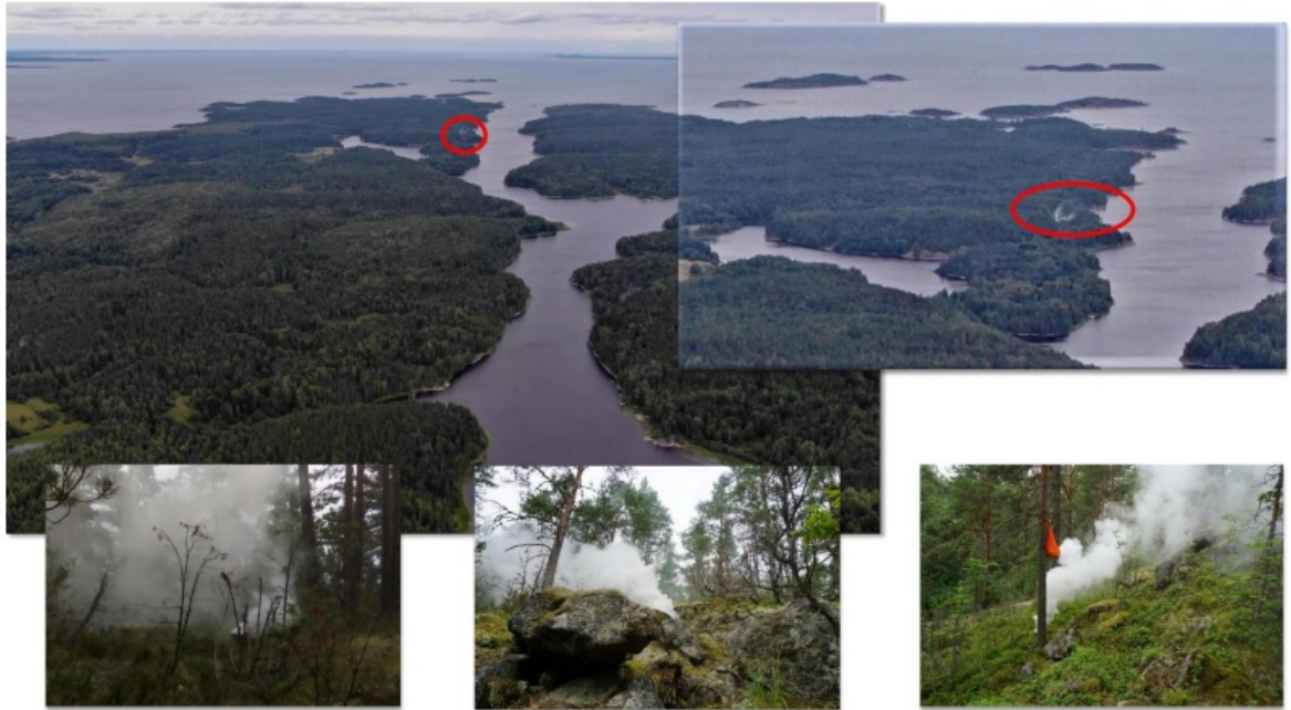
Тестирование на обнаружение очага начинающегося лесного пожара с помощью коптера (DJI Mavic 2). Дальность обнаружения дыма 9 км. Нижний ряд - фотографии с земли, для имитации пожара устанавливались дымовые шашки
