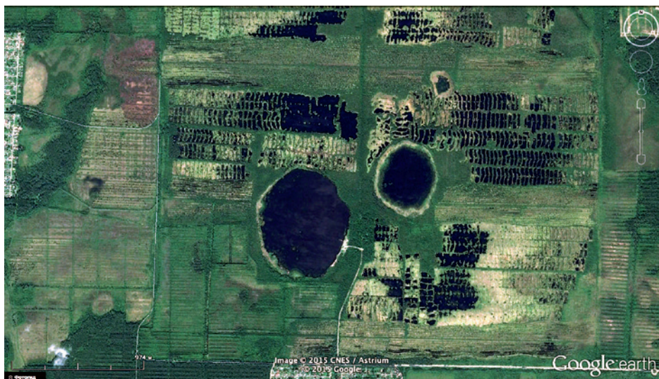
Рис. 6.3. Участок верхового болота, где добыча торфа велась гидроспособом, а впоследствии — фрезерным способом. Тверская область. Изображение (космический снимок) из Google Earth
