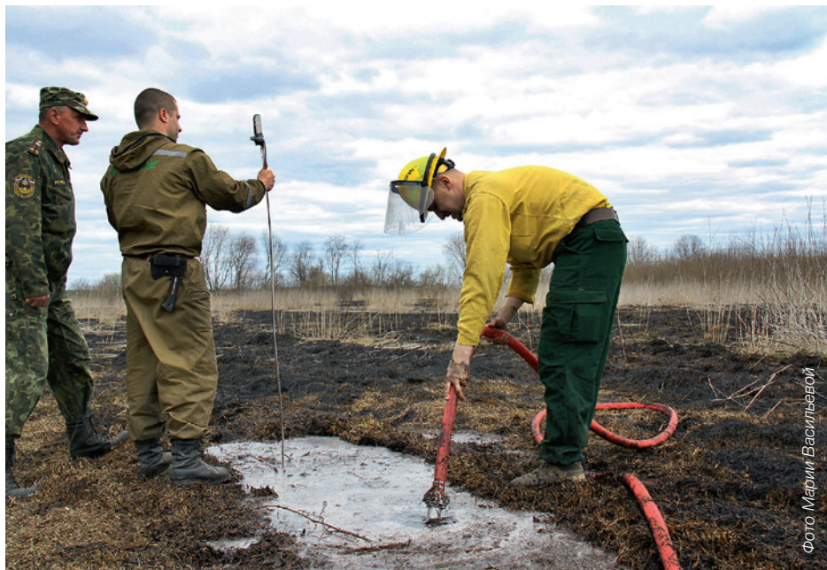
Рис. 12. Инструментальный контроль качества тушения небольшого очага. Рязанская область
