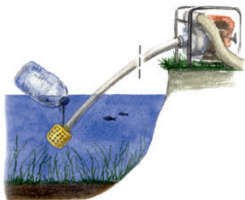
Рис. 55. Забор воды из водоёма с заиленным дном. Автор: Татьяна Хакимулина
