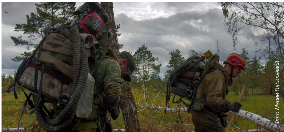
Рис. 44. Переноска лёгких мотопомп и рукавных линий для ликвидации торфяного очага в труднодоступной местности. Тверская область
