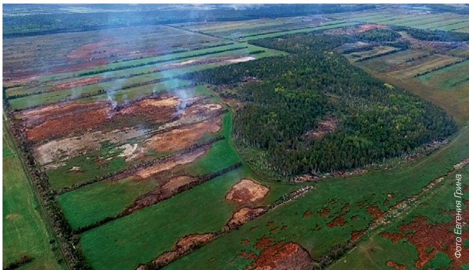
Рис. 43. Обследование горящего осушенного низинного болота с беспилотного летательного аппарата. Характерное расположение очагов тления торфа и завалов подгоревших деревьев. Осень. Бурятия
