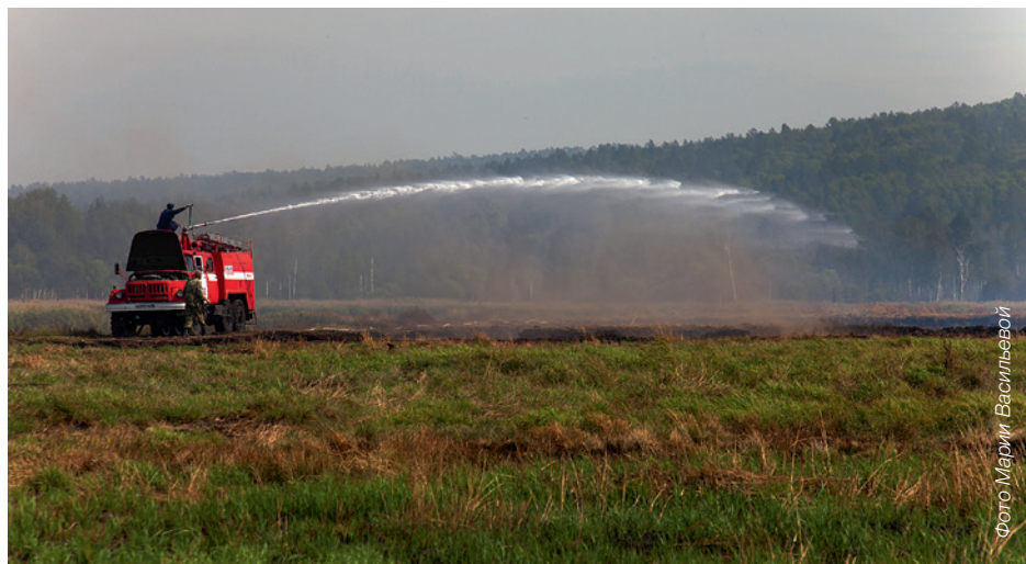
Рис. 34. Тушение от АЦ-40. Неправильно: лафетный ствол навесной струёй не обеспечивает надёжного тушения торфа. Иркутская область
