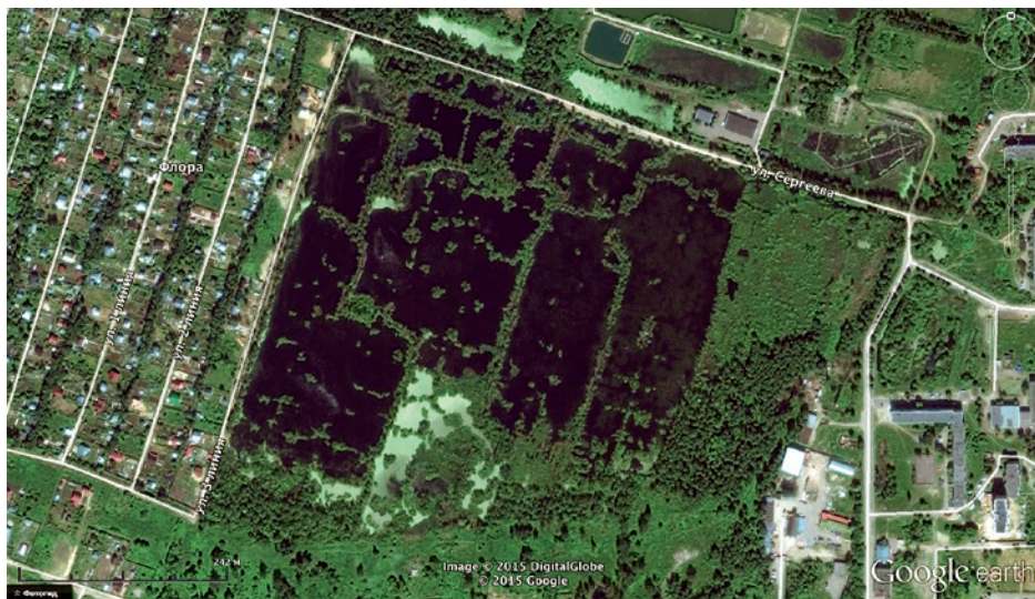
Рис. 6.4. Участок болота, на котором добыча торфа велась карьерным способом. Московская область. Изображение (космический снимок) из Google Earth
