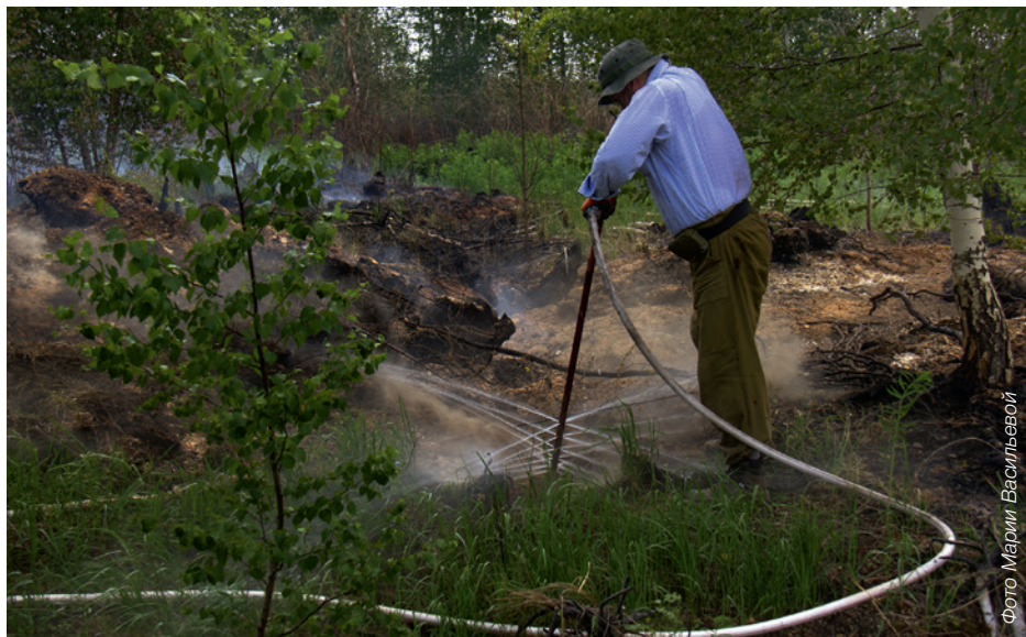
Рис. 16. Использование торфяного ствола ТС-1 на начальной стадии тушения бывшего торфяного штабеля. Впоследствии этот участок будет размыт компактными струями из ручных стволов. Владимирская область
